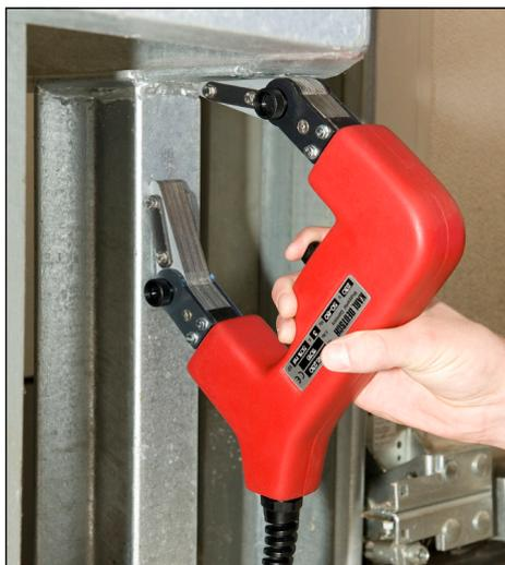
Handmagnet mit starren Vorsatzstücken
