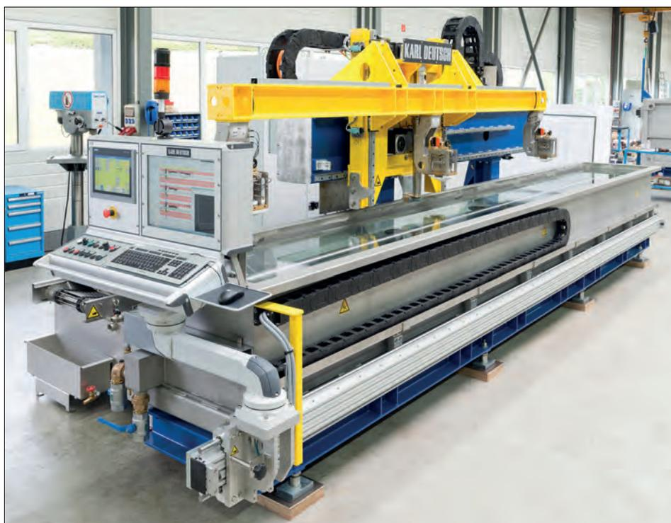
**ECHOGRAPH-TTPS Tauchtank zur Prüfung von Aluminiumstäben**
