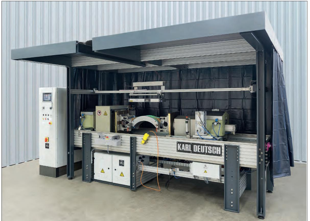
**Bild 3: Magnetpulver-Rissprüfmaschine DEUTROFLUX-UWS zur Prüfung von Rohrleitungsklemmsätzen**
