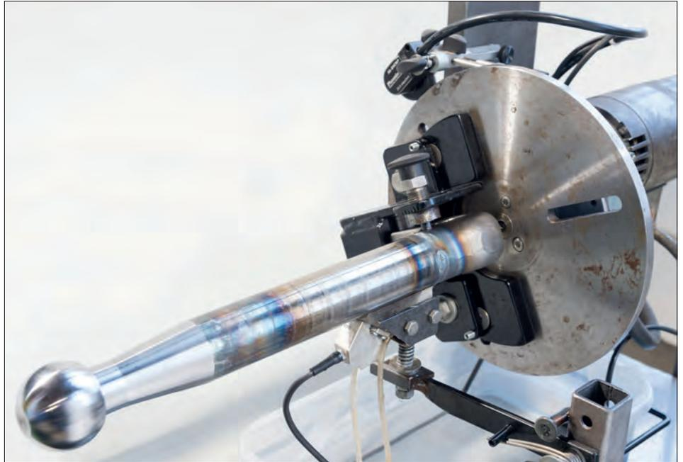
**Prüfmechanik der Fa. MVG zur Prüfung von Schweißnähten an Anhängerkupplungen. Der PA-Prüfkopf wird von unten über eine Feder an die Stange angedrückt. Die Wasserzufuhr zur Ankopplung erfolgt durch die beiden hellen Schläuche über eine kleine Pumpe. Links oben auf dem Drehteller sieht man den Radencoder zur Aufnahme der Stangendrehung.**
