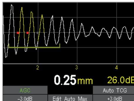
Bild 2: A-Bild-Anzeige bei der Wanddickenmessung an dünnem Stahlblech
