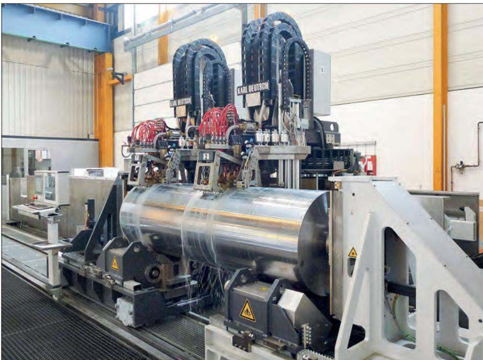
ECHOGRAPH-RPTS Prüfportal für Stäbe bis zu 1 m Durchmesser mit Wasserspaltankopplung
