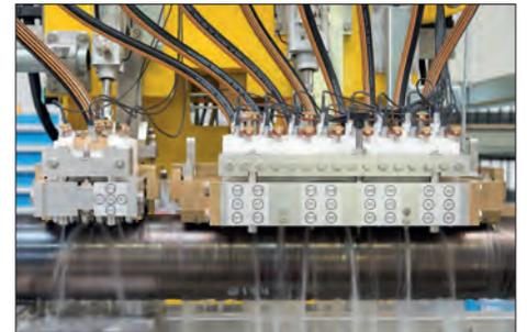
ECHOGRAPH-RPTS Insgesamt sind 21 Prüfköpfe in den beiden Prüfkopfhaltern verbaut.
