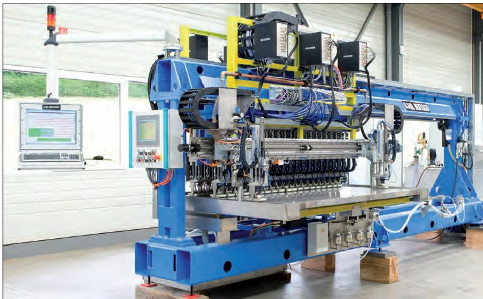
ECHOGRAPH-BAPS Bandprüfanlage mit 41 Prüfköpfen, die im Bild in der Service-Position zu sehen sind
