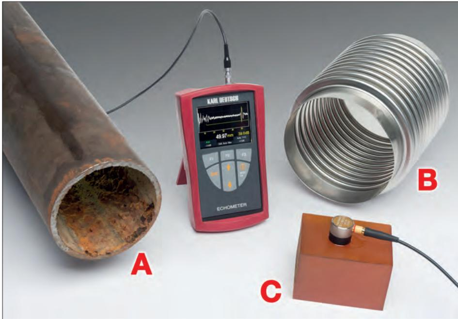
Bild 1: Das A-Bild-ECHOMETER 1077 mit anspruchsvollen Materialproben: A) Rohr mit stark korrodierter Innenwand und Lochfraß, B) Edelstahlbalg mit dünner Wanddicke, C) Schallschwächender Kunststoff mit großer Wanddicke
