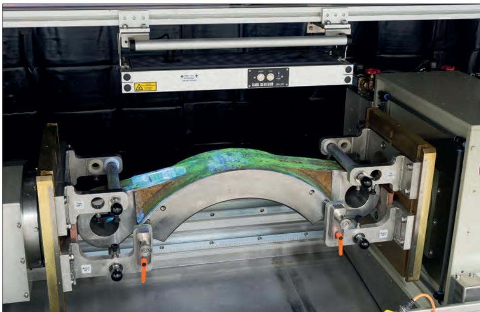
**Bild 4: Visuelle Untersuchung von Rohrleitungsklemmsätzen unter UV-Licht. Das Prüfteil kann in der Maschine gedreht werden.**
