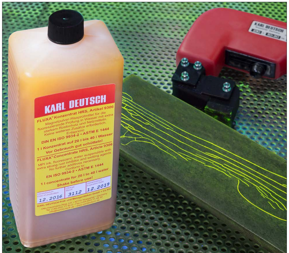
Kontrastreiche Rissanzeigen mit neuer FLUXA-Rezeptur
