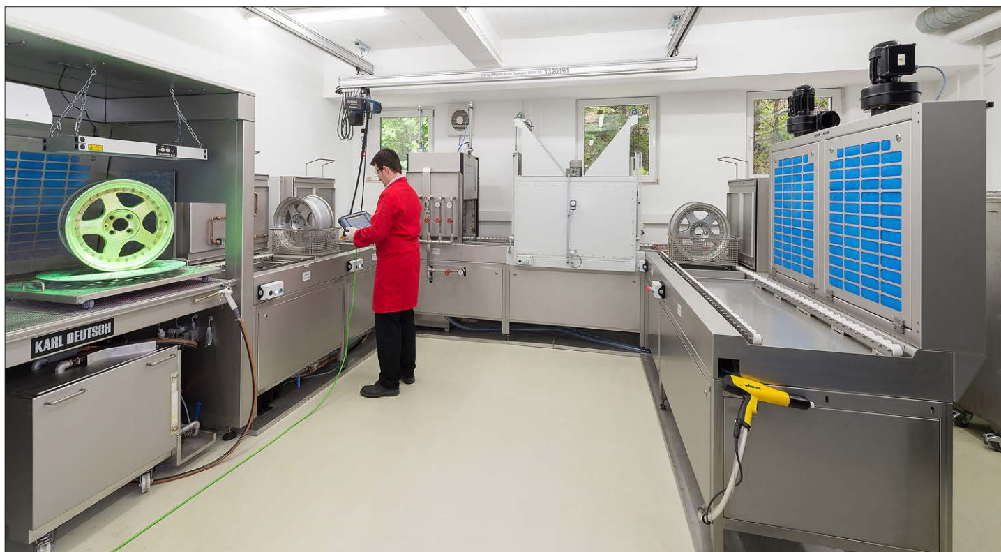
PT-Prüfplatz (links) und u-förmige PT-Anlage im Technikum von KARL DEUTSCH
