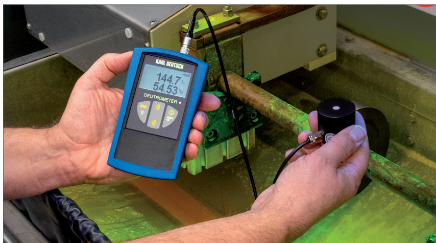
为了控制观看条件，DEUTROMETER和DEUTROLIGHT探头同时提供剩余日光和紫外线强度的测量值
