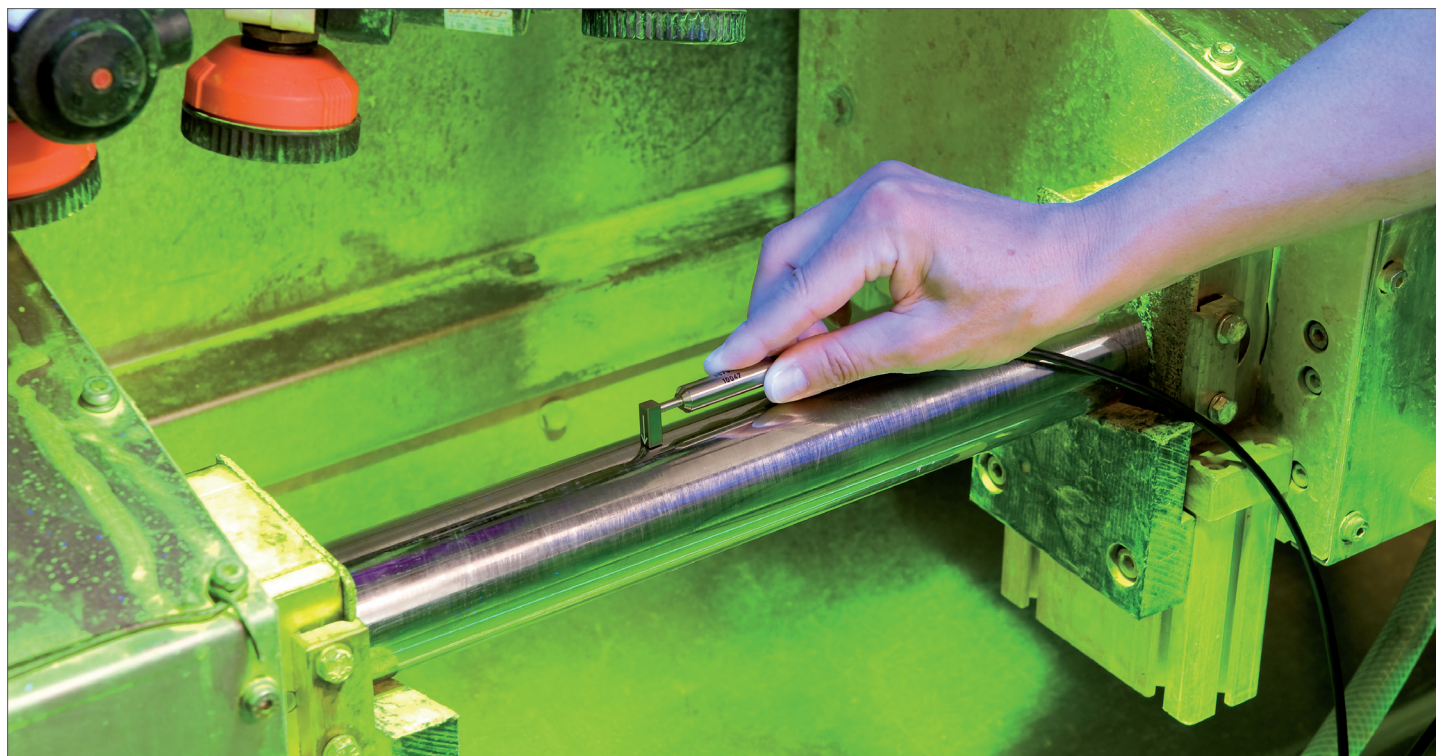
应用实例: 使用90°带场流探头进行切向场测量
