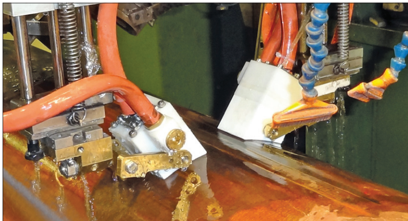
探头水嘴1598.666 和 1598.649, 水嘴与工件曲面匹配, 如 钢管焊缝检测
