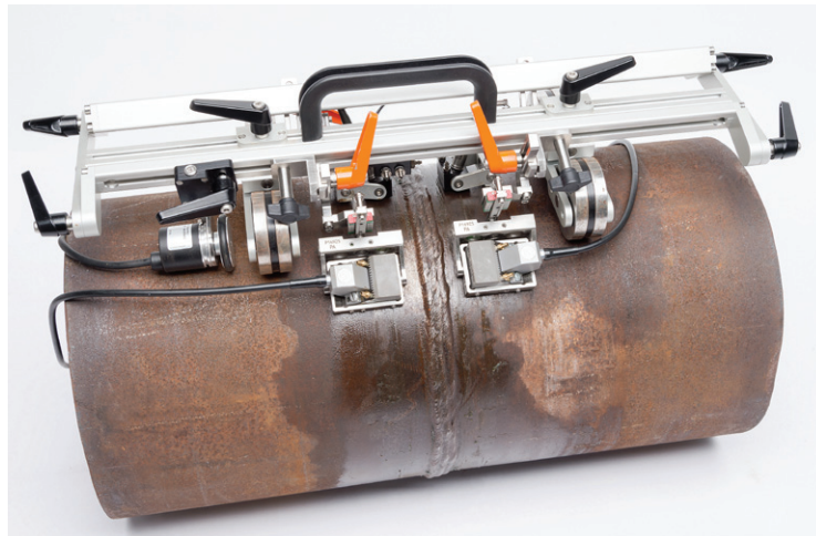
钢管环焊缝手动扫查，带编码器，2个相控阵探头和2个 TOFD-探头
