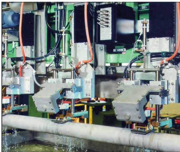
图例：此图中，每个探头架里有一个直探头。每个探头架上设置有一个较大的金属滑块保护着探头和水嘴免于受损。被检的铸铝坯件表面比较粗糙。
