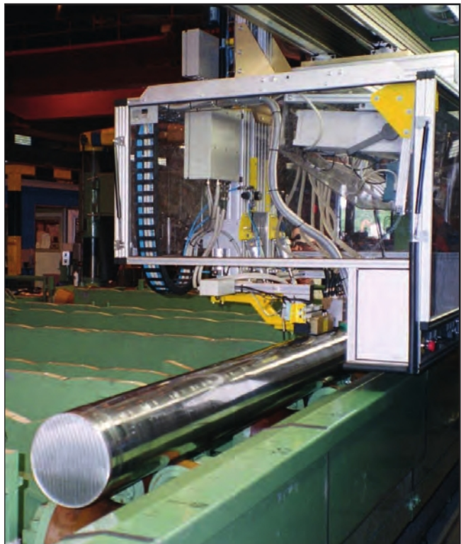
一个探头架上配备多组探头的测试门架。工件由一个横向输送机（步进机构）上料至检测位置。检测完毕后，由一个直线输送机构下料卸载。
