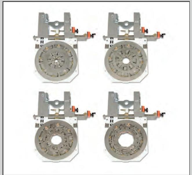
带有超声波探头架的检测室：斜探头用于检测表面缺陷，直探头用于检测中心缺陷。所有斜探头的检测角度通过主轴和橙色表盘调节。
