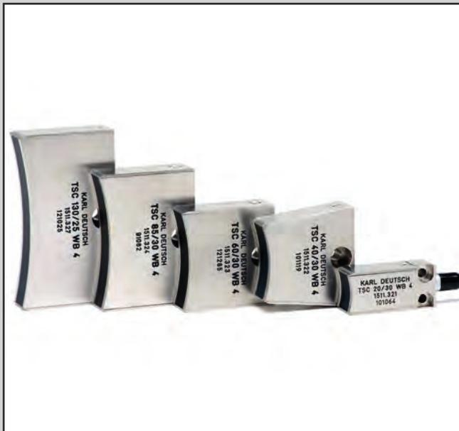
不同入射角的特殊的线聚焦探头，用于检测不同直径的棒材。每个探头的覆盖率为棒材轴向30度范围，与棒材表面的距离约30到70mm。
