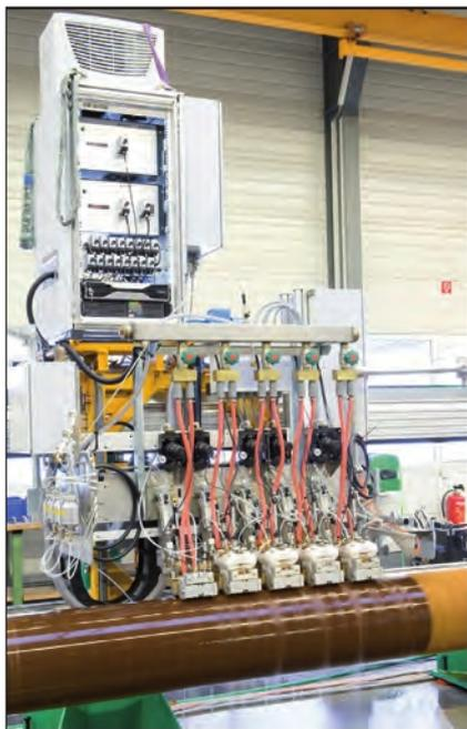
龙门架式超声波检测系统：可配置用于检测纵向缺陷、横向缺陷和夹层壁厚的检测探头架。或也可采用相控阵检测探头架。
