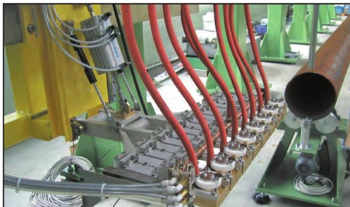
检测钢管焊缝的纵向缺陷(ERW 高频电阻焊管):在这个例子中, 采用8个超声波检测探头。根据产量和覆盖率要求, 无论是用宽频双晶探头水膜法耦合还是用单晶探头射流法耦合, 都可以实现上述检测功能。系统上的每个探头架均固定在导向装置上, 以保证在检测过程中探头与钢管表面能良好的耦合。
