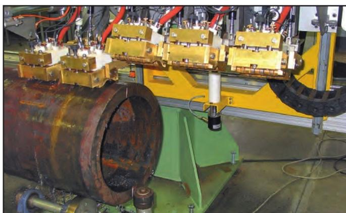
钢管检测探头架上5个探头的入射方向: 在这个例子中, 每个探头架上固定了5个超声波探头, 每个探头都可以单独的控制其降低或升高, 这就可以实现系统对钢管管端的检测。通过射流耦合技术可以获得稳定的耦合条件。通过探头入射角度的调整可以很好的控制纵向和横向缺陷的检测, 钢内的折射角一般选择为45°左右。探头架上配置的直探头则用来检测钢管的夹层和壁厚。
