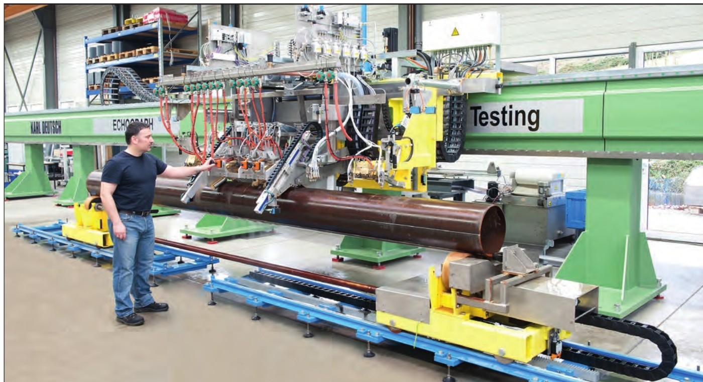
图例：在德国卡尔德意志检测仪器设备有限公司总部工厂内的离线检测系统，包括检测大梁
