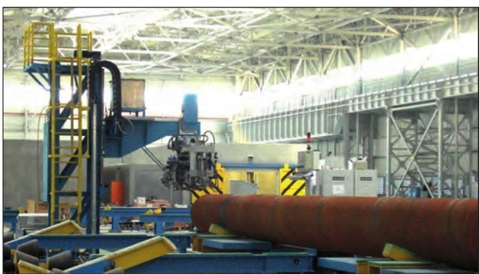
图例：钢管由一个控制台架操纵。钢管的直线运动和旋转进给必须严格同步（图片由土耳其 Borusan Mannesmann Turkey 公司提供）。
