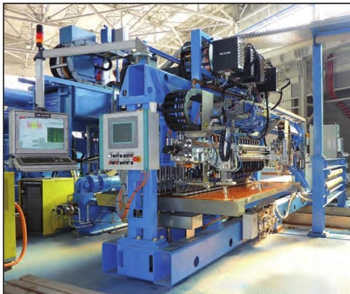
图例：带钢检测机械，包括有一个宽度为带钢宽度两倍的检测桥架。探头架可以在检测工位（在线）和校准工位（离线，如图）间移动。
