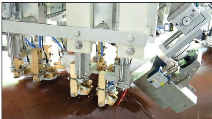
图例：由激光跟踪系统控制的焊缝局部图。
