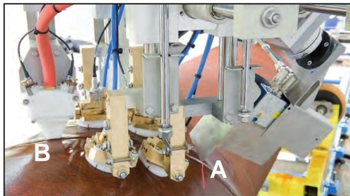
图例：带六个超声波探头的检测探头架，其焊缝跟踪系统为激光跟踪器：A) 纵向探头与焊缝的距离（水层）可以很方便地调节；B) 检测焊缝横向缺陷的探头也安装在同一个探头架上。
