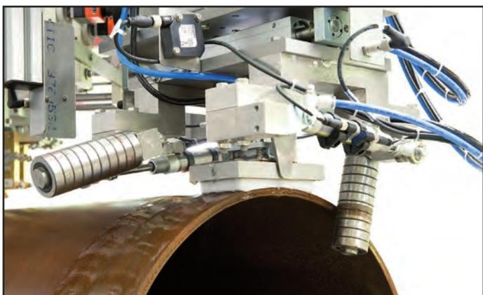
图例：管端检测采用的是一个 50mm 宽的刷型探头。管端的检测路径由一组钢辊实现其精准定位。钢管的两端用的是同一个探头架（第二组定位钢辊处于待机状态）
