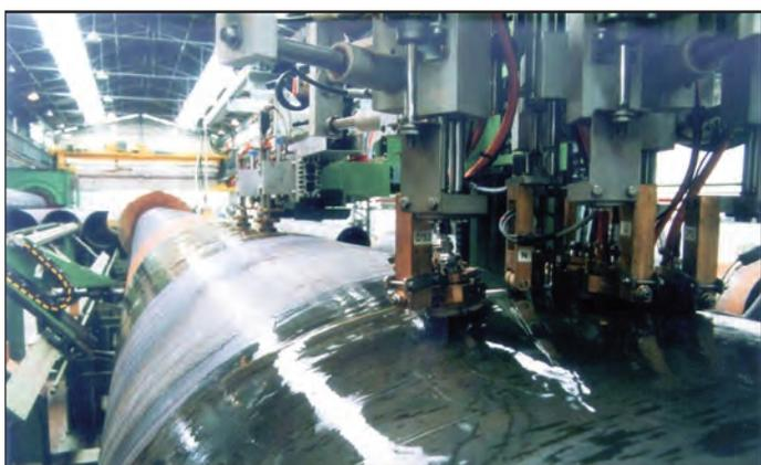
图例：钢管管体也可在焊接后检测（而不必检测带钢）。探头的数目根据要求的覆盖面积和焊接速度而定。通过探头的摆动运动可以进一步提高覆盖率。
