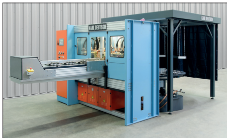
带观察室的常规DEUTROMAT磁粉检测系统示例
