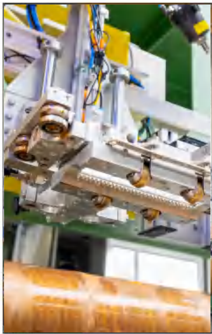
无缝管相控阵超声波检测系统可配置不同探头架，支持检测钢管的纵向、横向缺陷及夹层壁厚测量。
