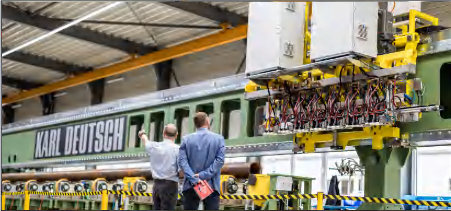
无缝管超声波相控阵自动检测系统装配现场：黄色的机械装置为校准台，通过短样管实现对所有探头灵敏度的统一校准，保障检测一致性。当前探头架放置于管材上，可直接开展实时检测，系统可支持不同长度管材的检测需求。技术配置上，该系统采用多通道并行相控阵检测技术，通过电子束角度动态调整与声速重叠控制，实现超声波束的精准指向性与覆盖性，显著提升复杂管材缺陷的检测精度与效率，满足现代化高规格管材检测需求。
