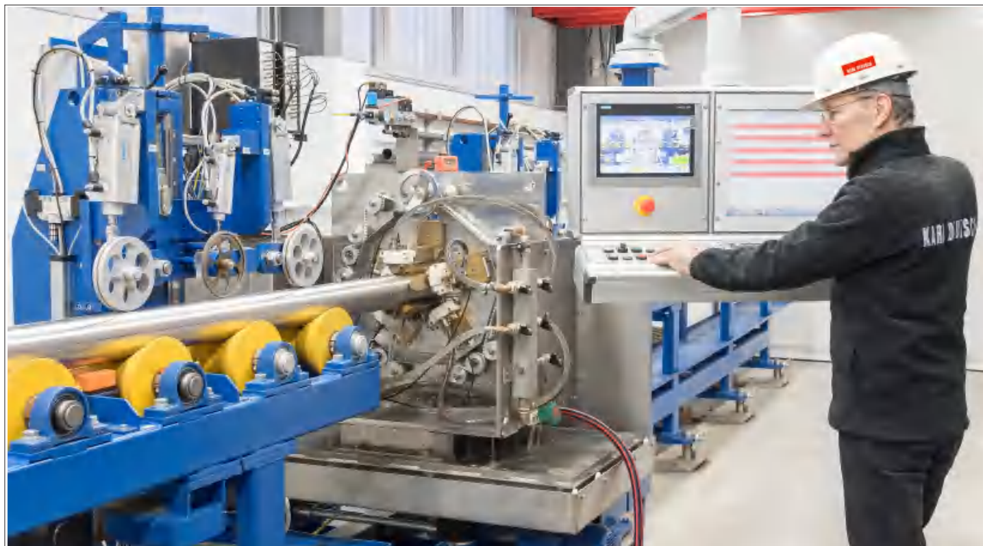
德国卡尔德意志应用实验室的棒材相控阵超声波自动检测系统
