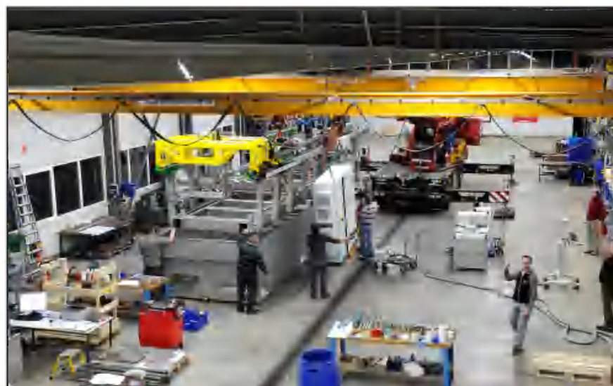
实例：大型水浸检测箱的组装过程
