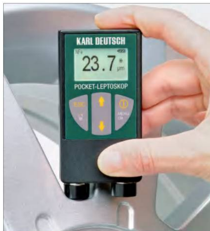
装有内置探头的紧凑型(口袋型)膜层测厚仪 (Pocket-LEPTOSKOP® 2026)
