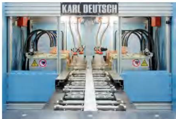
DEUTROMAT 带有传送链，一次检测8个工件
