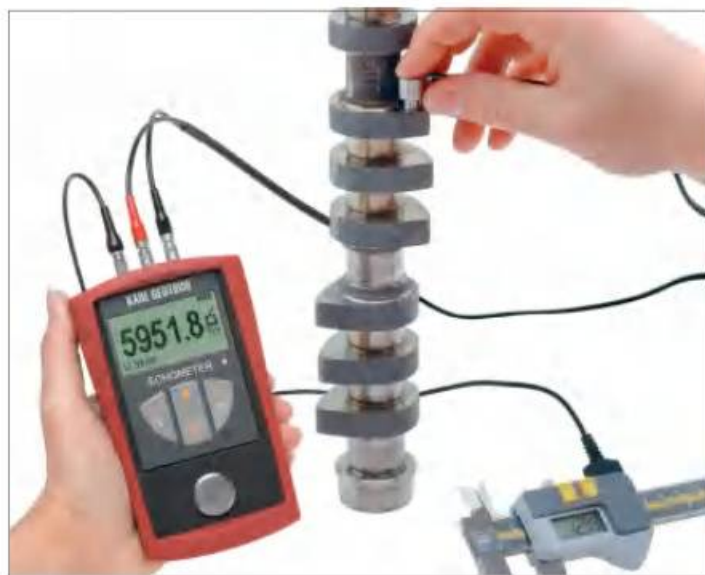
测量凸轮轴材料声速 (ECHOMETER 1076)
