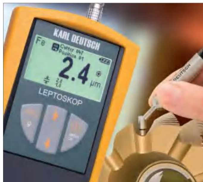
可外接不同探头以满足不同要求的膜层测厚仪 (LEPTOSKOP® 2042)
