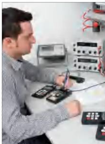
裂纹测深仪出厂测试
