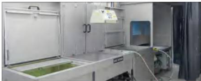
KD-Check® 多工位渗透探伤设备，用于批量产品的探伤
