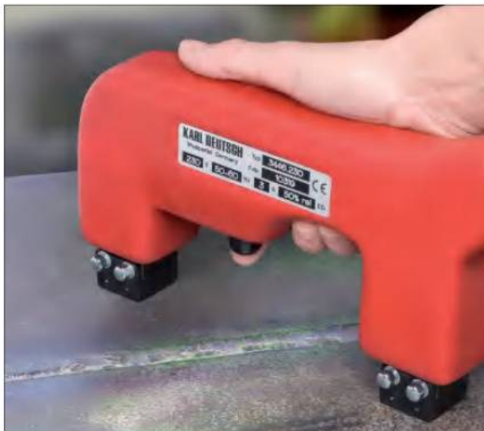
使用手持式磁探钳检测焊缝质量 (DEUTROPULS 3446)
