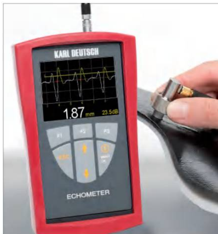
带有A扫功能的测厚仪 (ECHOMETER 1077)
