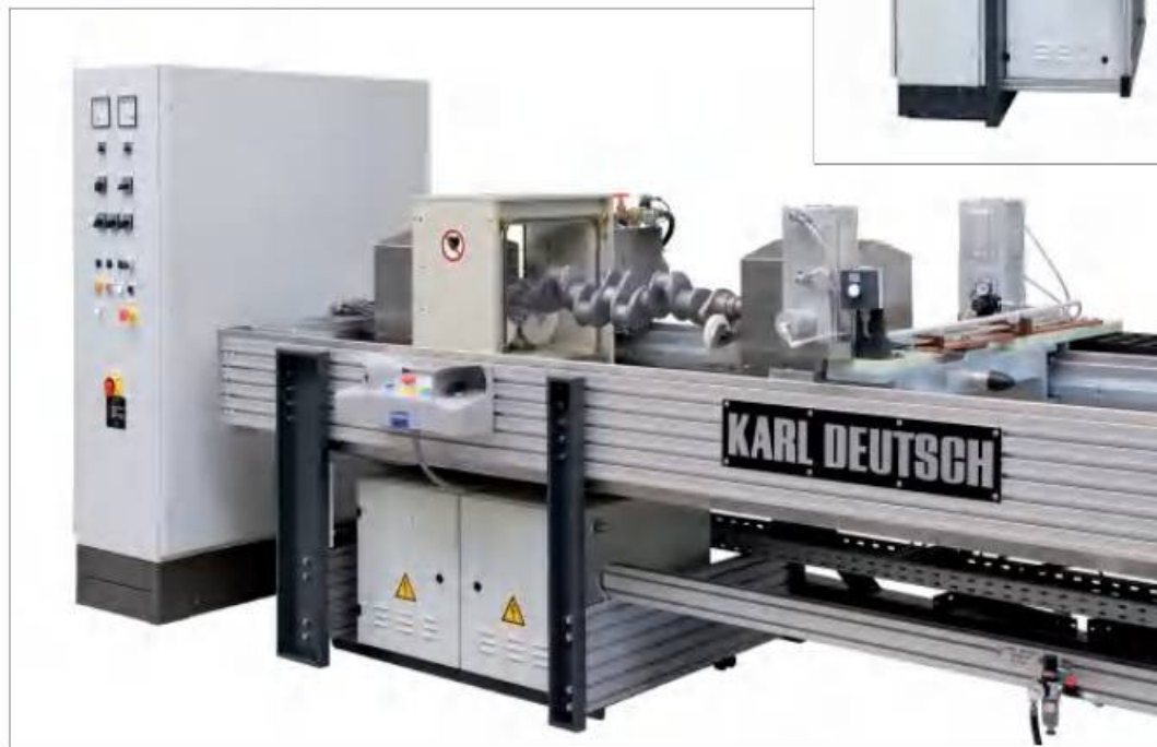
使用带有移动线圈的磁粉探伤机 (DEUTROFLUX® UWS 2500)检测曲轴
