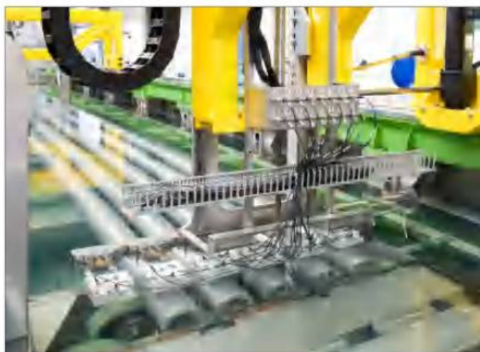
水浸式超声波自动检测设备 此设备配有多个探头
